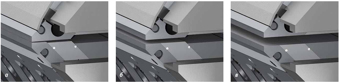
Фото 2. Система SmartGap позволяет настраивать зазор и длину формирующей фильеры в различных диапазонах – от минимального (а) до среднего (б) и максимального (в)
